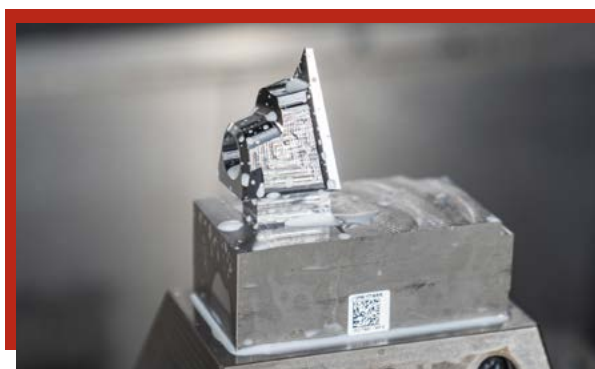
Pro různé plastové komponenty, jako je tento kryt žehličky, konstruuje Hofmann nářadí s talířovým kotoučem.
